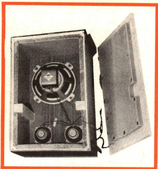
Fig. 3 - Cassa acustica di laboratorio che impiega gli altoparlanti A/463 ed A/458.
